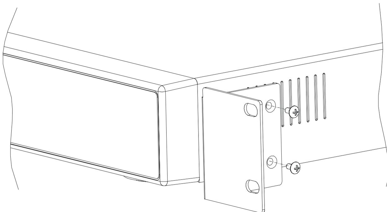
Установка в стойку. Вид сзади
