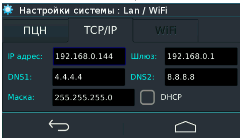
Рисунок 24. Настройки сети Ethernet
