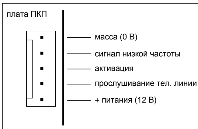
Рис. 13. Гнездо для подключения модуля речевого оповещения.
